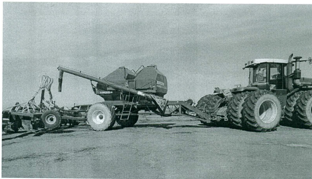
Рисунок 1 – Рыхлитель-удобритель для дифференцированного внесения минеральных удобрений, вид слева в транспортном состоянии
