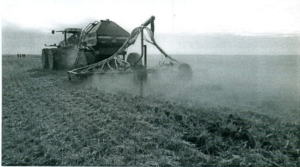
Рисунок 3 –Рыхлитель-удобритель для дифференцированного внесения минеральных удобрений, в работе
